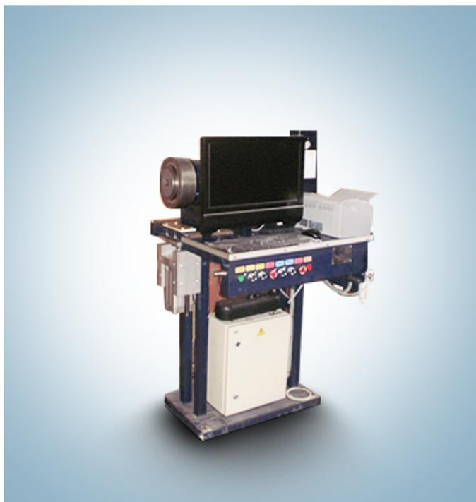
Стенд вибродиагностики подшипников качения предназначен для проведения контроля технического состояния подшипников качения в роликовых отделениях цехов при ремонте подвижного состава.
