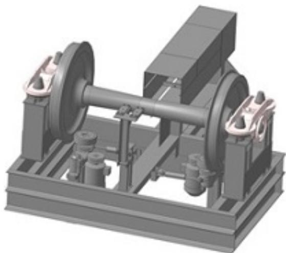
Стенд вибродиагностики колёсных пар пассажирских вагонов предназначен для определения технического состояния и выявления неисправностей подшипников буксовых узлов и редукторов ВБА и ЕЮК. Стенд позволяет проводить диагностику пассажирским колесным парам как с редукторами ВБА и ЕЮК так и без них.
