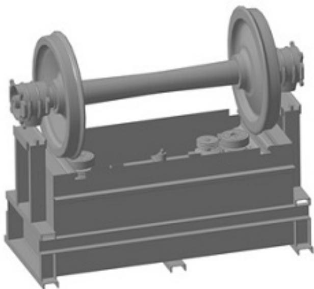
Стенд предназначен для вибродиагностики подшипников буксового узла колесной пары без его разборки. Стенд оснащён гидроцилиндром, обеспечивающим подъём и опускание колёсной пары для установки букс колесной пары на опоры.
