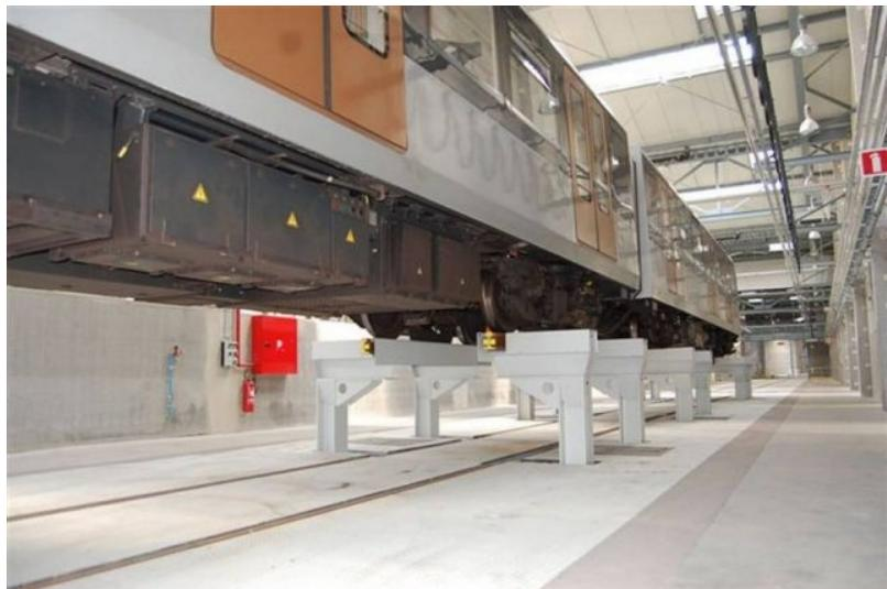
При исполнении подпольной подъёмной установки с консолью, меняемые тележки можно выкатывать и закатывать под поднятым поездом. Это выгодно, когда ограничено пространство.
