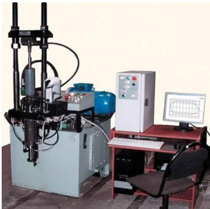
**Стенд позволяет** вести протокол измерений с идентификацией номера испытуемого оборудования (создание электронного паспорта) и слесаря, проводившего его ремонт и испытание, а также производит объективную оценку качества ремонта, регистрацию на печатающем устройстве информации о техническом состоянии испытанного оборудования и архивацию полученных результатов в виде актов технической готовности
