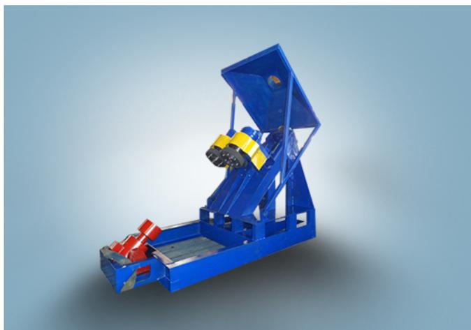
Установка прокрутки якорей предназначена для циклической прокрутки якорей различных типов двигателей после пропитки.
