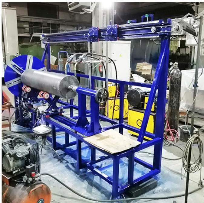
**Назначение:** Сварочная установка предназначена для автоматизации процессов сварки кольцевых и продольного швов ресиверов до 2000 мм длиной.
